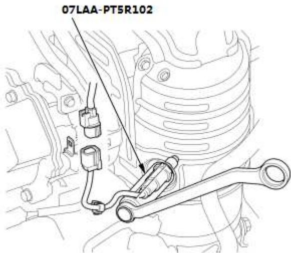
2. 用传感器套筒扳手拆下辅助 HO2S。
